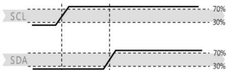
图11 停止传输状态(P) -当SCL高电平时，SDA线上从低电平转换为高电平。停止状态是由主机控制的一种特殊的总线状态，指示从机传输结束(Stop之后，BUS总线一般被认为处于闲置状态)。
